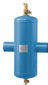
ZEPARO ZIK..S Соединение под сварку для микропузырьков и частиц шлама PN10, PN16, PN25 DN50-DN600
