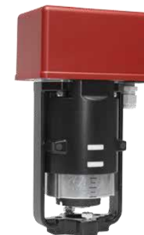
TA-MC100 FSE/FSR с возвратной пружиной FSE: Шток выдвигается при отключении питания FSR: Шток втягивается при отключении питания 24 В AC/DC пропорц. / 3-точ. 230 В AC 3-точ.
