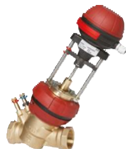
TA-FUS10N-C DN 32-150, PN16/25, -20/150 °C настраиваемый Kvs Для пропорц. /3-точ. рег. Равнопроц. (EQM)
